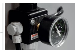
Anzeige und Regulierung des Eingangsdruck mit Filter
